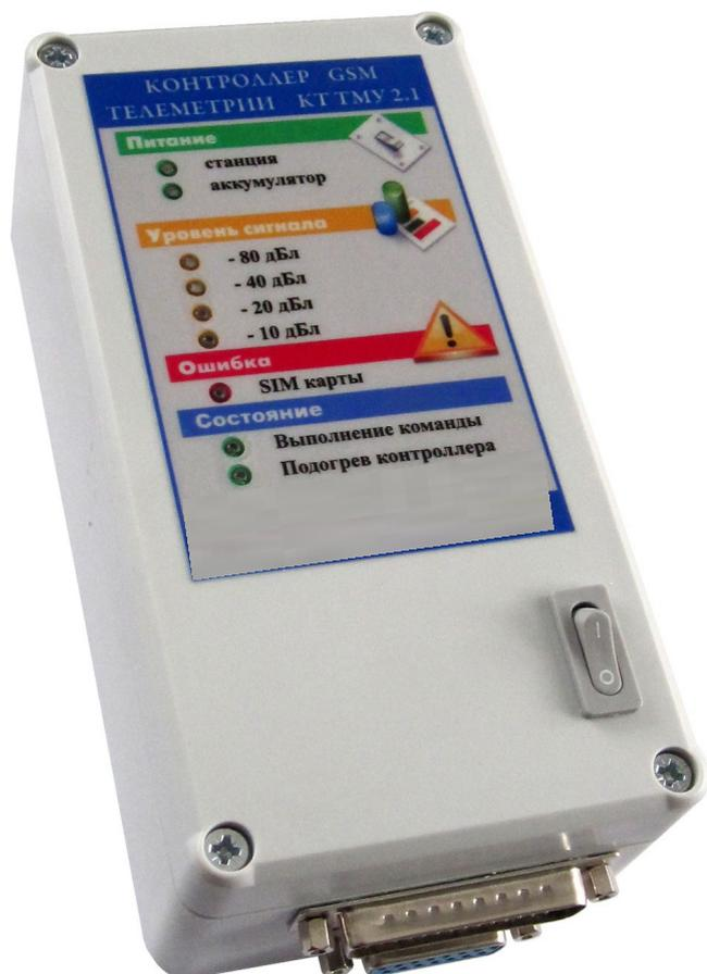
Контроллер GSM телеметрии предназначен для дистанционного сбора информации о состоянии станций катодной защиты в режиме реального времени и управления всеми режимами работы станций. К нему могут быть подключены любые станции катодной защиты с аналоговыми стандартными и нестандартными интерфейсами без дополнительных согласующих блоков.
