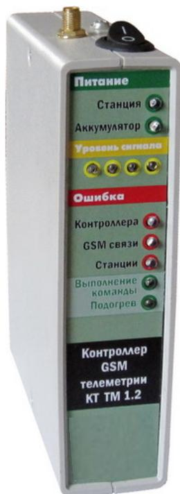
Контроллер телеметрии предназначен для дистанционного сбора информации о состоянии станций катодной и усиленной дренажной защиты типа "ТИЭЛЛА", показаний счетчиков электроэнергии и состояния датчиков охраны в реальном режиме времени и управления всеми режимами работы станций. Контроллер работает в составе системы телеметрии, под управлением программного обеспечения компьютера диспетчерского пункта. Связь контроллера с диспетчерским пунктом осуществляется по любой сотовой сети стандарта GSM.
